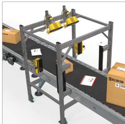
Túnel de exploración de varios lados
